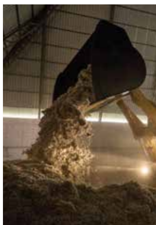
Leichtgutschaufel der Performance-Serie
